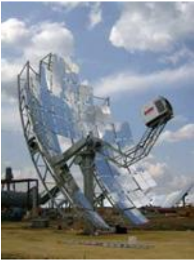
Disco Stirling con diseño propio Abengoa Solar
