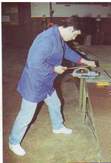
Fig. 3. Posición correcta de limado.
