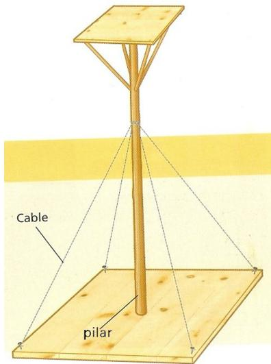
3 - **Tirantes:** Con objeto de dar rigidez a las estructuras se dispone de unos elementos simples que se colocan entre las vigas y los pilares. Por ejemplo las tijeras de los andamios (oblicuas), esa barra *horizontal* donde apoyas los pies en el pupitre, etc.
