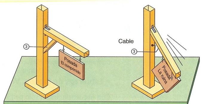
Elemento estructural sometido a esfuerzo de compresión
