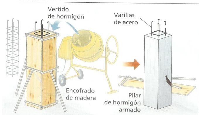
El hormigón es el material más usado en la construcción. El **hormigón** es una mezcla de cemento, arena, grava y agua. Si al hormigón se le añade un *entramado de acero* para hacerlo más resistente, se lo denomina **hormigón armado**.
