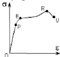
8. La figura adjunta muestra el diagrama de tracción de un material. Comente las características principales de los intervalos O-P, P-E, E-R y R-U (0.5 puntos).
