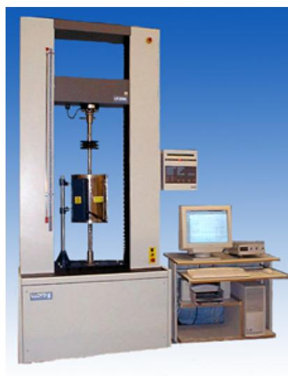
Consideremos una probeta de longitud  $l_0$  y una sección  $A_0$  sometida a una fuerza  $F$  norma de tracción (perpendicular a la sección de la probeta).
