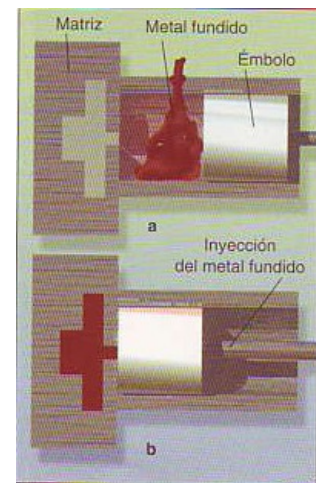
Fig. 6. Proceso de inyección de metal fundido en la matriz.
