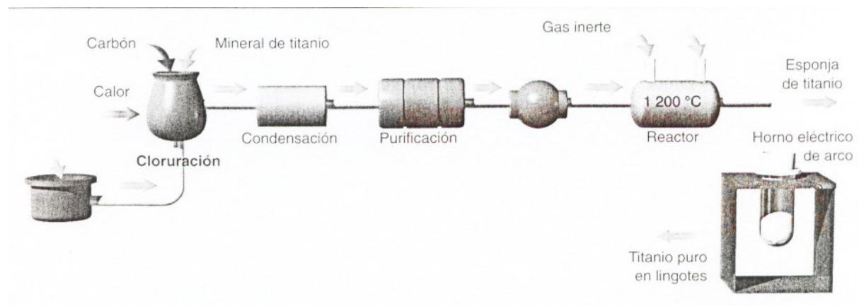
El procedimiento mas utilizado en la industria consiste en la cloruración o transformación del óxido en tetricloruro de titanio a temperatura elevada. Una vez condensado y purificado, este compuesto es reducido en atmósfera inerte en un reactor y se obtiene la denominada esponja de titanio. Posteriormente, la esponja se funde en un horno eléctrico y se obtienen los lingotes de metal.
