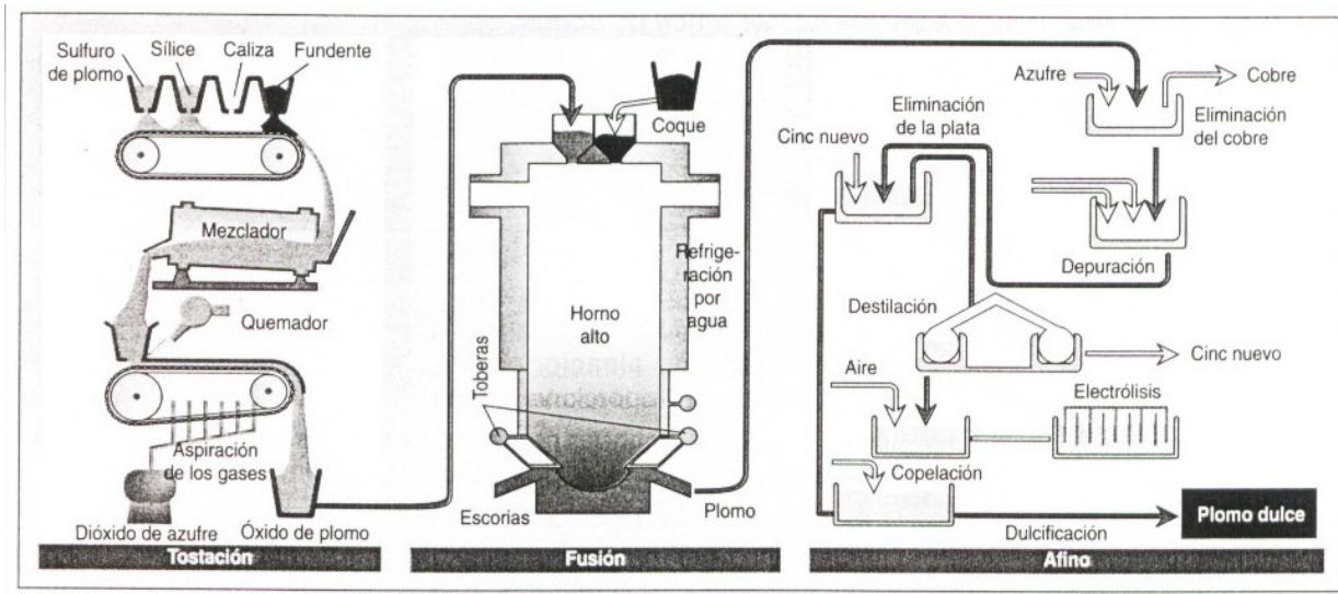
En la **fase de tostación**, la galena se mezcla con sílice, caliza y material fundente, y se calienta en presencia de aire hasta que el sulfuro de plomo se convierte en óxido.
