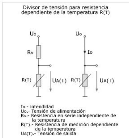
En este esquema se ve un ejemplo de un divisor de tensión que funciona como sensor de temperatura.  $R_v$  es la resistencia fija, mientras que  $R(T)$  es la resistencia que depende de la temperatura (NTC, por ejemplo).
