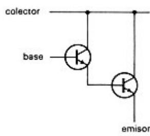
Está constituido por dos transistores y sirve como circuito amplificador de **alta ganancia** fija. Los dos transistores se conectan de modo que el emisor del primero se conecta a la base del segundo, de modo que la corriente que emite el primero será amplificada por el segundo transistor.
