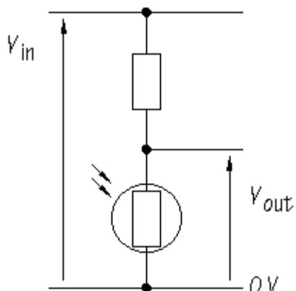
Si la luz ambiental aumenta sobre la resistencia LDR  $\rightarrow R_{LDR} \downarrow \rightarrow V_{out} = V_{LDR} \downarrow \rightarrow$  que es la tensión de salida, que puede derivarse para desactivar un transistor, o un tiristor, o un amplificador operacional, etc). Justo al contrario que el caso anterior.
