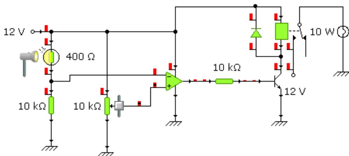
En este caso, al estar el LDR formando parte de un divisor de tensión por encima de la resistencia fija de 10 K, el amplificador operacional funciona como un **comparador** (ver teoría de amplificadores operacionales). De
